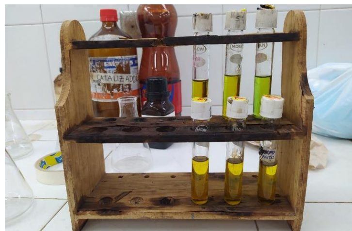
Ilustración 20. Montaje prueba de DQO. Fuente: Autores, 2021.
