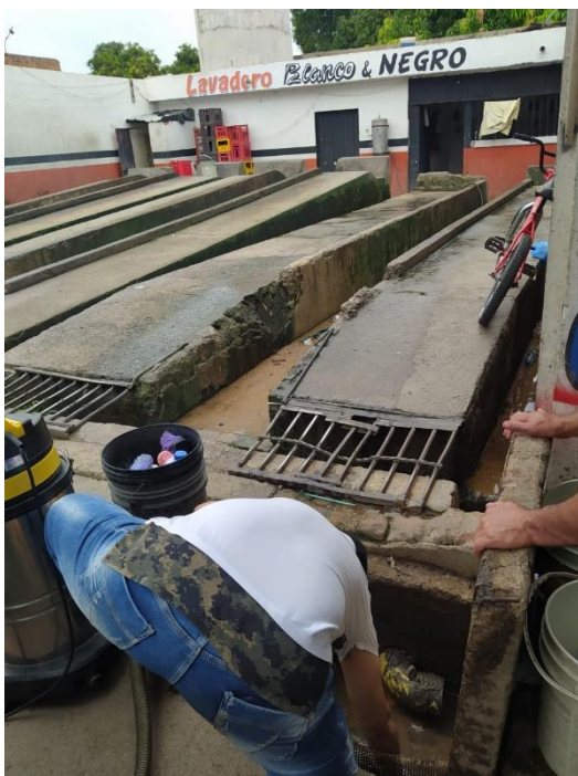
Ilustración 18. Toma de Muestra caja de registro: Lavadero Blanco y Negro. Fuente: Autores, 2021.
