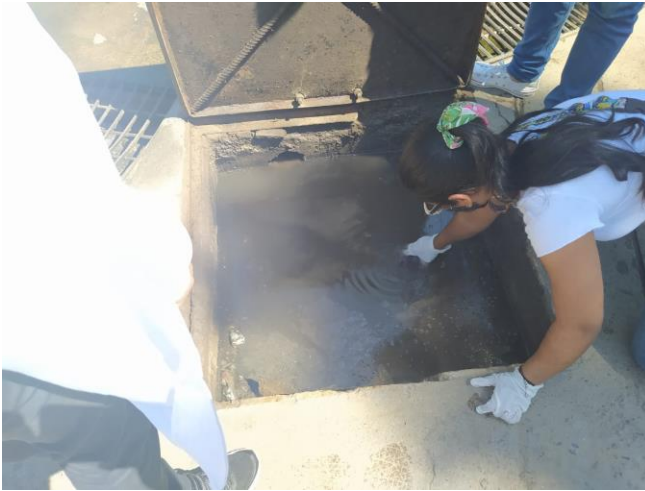
Ilustración 5. toma de muestra caja de inspección lavadero Los Manguitos.
