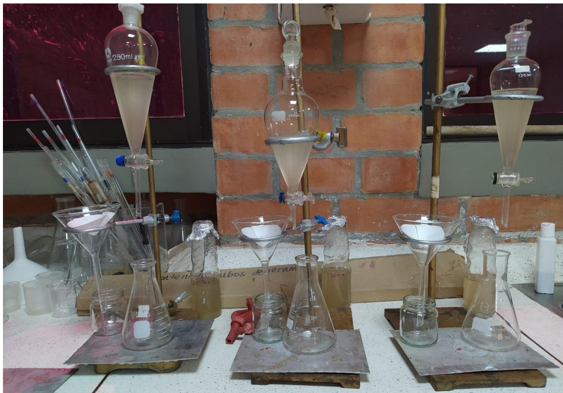
Ilustración 19. Montaje prueba de Aceites y Grasas. Fuente: Autores, 2021.
