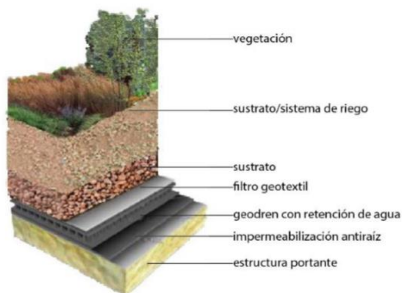
Figura 2. Sección de techo verde intensivo
