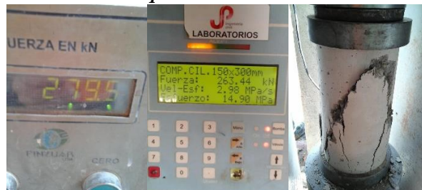
Ilustración 17 Cilindro con adición de Diatomeas al 15%. Fuente: Autores
