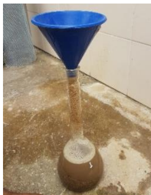
Ilustración 8 Densidad aparentemente seca Fuente: Autores
