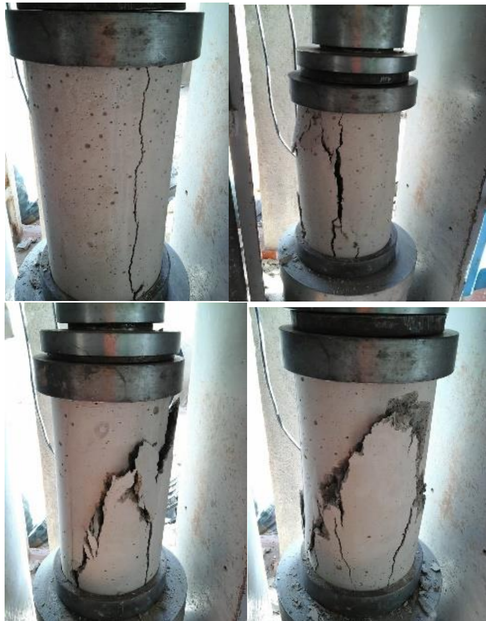
Ilustración 13 fallas de cilindros a los 28 días Fuente: Autores
