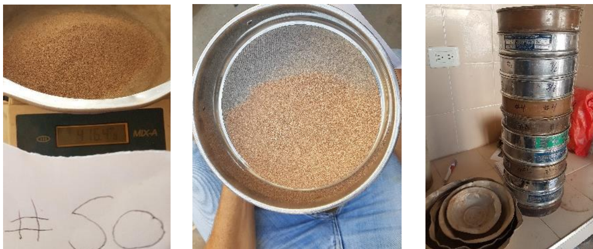
Ilustración 9 Tamizado agregado fino Fuente: Autores
