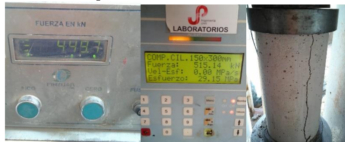
Ilustración 14 Cilindro Patrón. Fuente: Autores
