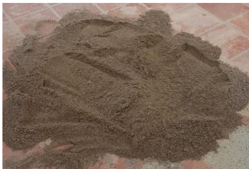
Ilustración 5 Muestra agregado fino Fuente: Autores
