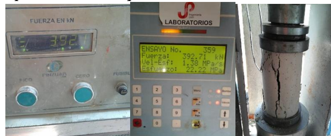
Ilustración 15 Cilindros con adición de Diatomeas al 5%. Fuente: Autores
