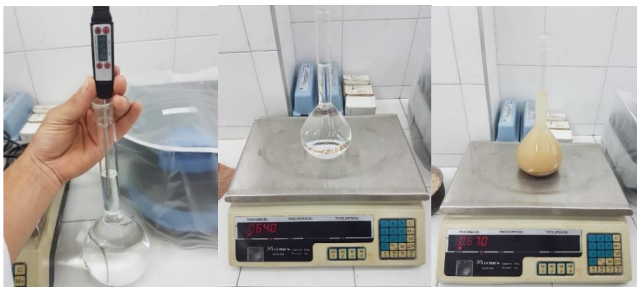
Ilustración 3 Gravedad específica diatomeas
