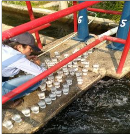
Fotografía 12. Toma de muestra en floculador
