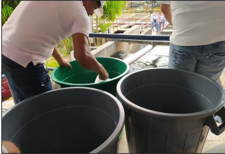
Fotografía 9. Tanques para dilución del trazador
