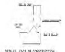
DETALLE JUNTA DE CONSTRUCCION
