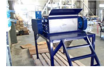
Figura 7: Molino a Rodillo Triturador de Piedras y Terrones de Sal Fuente: Tomado y adaptado de BurMaquinas 11
