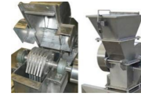
Figura 9: Molino de martillos Fuente: Tomado y adaptado de Inducam 13
