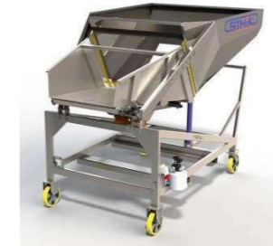
Figura 5: Tolva vibrante Fuente: Tomado y adaptado de Az3 Oeno 9
