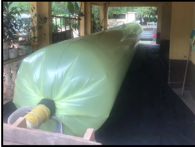
Imagen 39. Prueba del plástico en busca de fugas. Fuente: Autores
