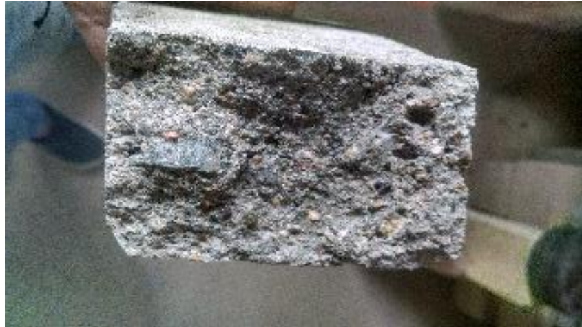
Ilustración 15: adoquín luego de ser ensayado a flexión.
