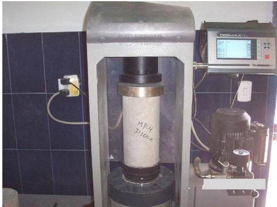
Ilustración 4: ensayo de resistencia a la compresión.
