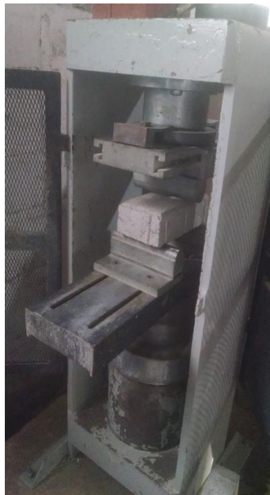
Ilustración 5: ensayo de resistencia a la flexión de adoquines.
