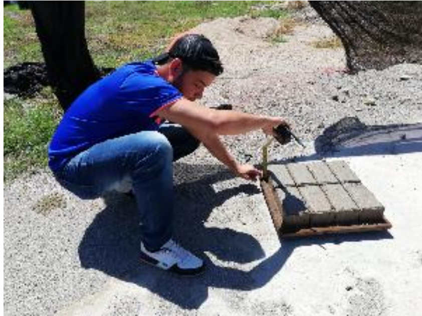
Ilustración 12: medición de los adoquines terminados
