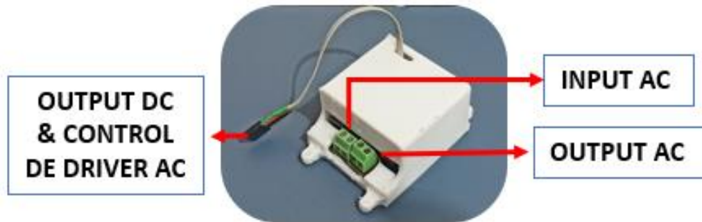
Figura 33. Ensamble final de PCB de power y driver AC.
