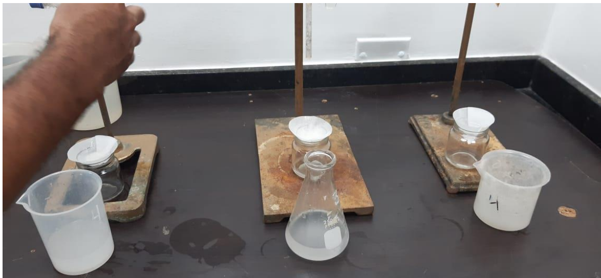
Anexo 9. Montaje de prueba DQO
