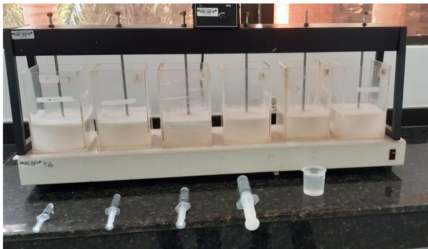
Anexo 6. Antes y después de la prueba de jarras utilizando el coagulante natural de escama de pescado.
