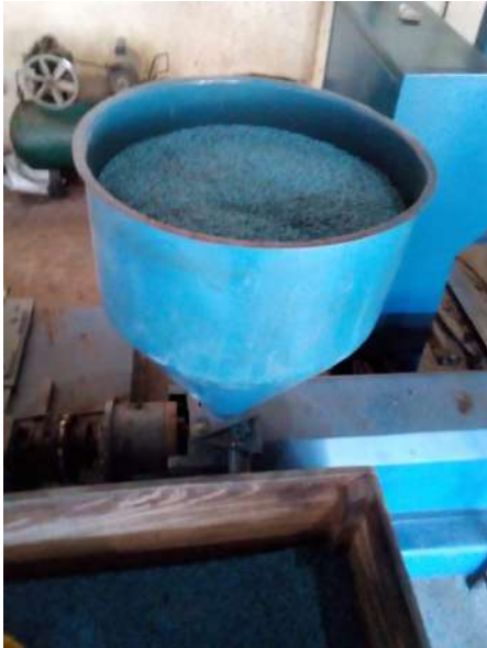
Figura 11 Polietileno granulado en la maquina extrusora
