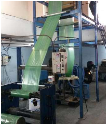
Figura 12 Película de plástico en la maquina extrusora
