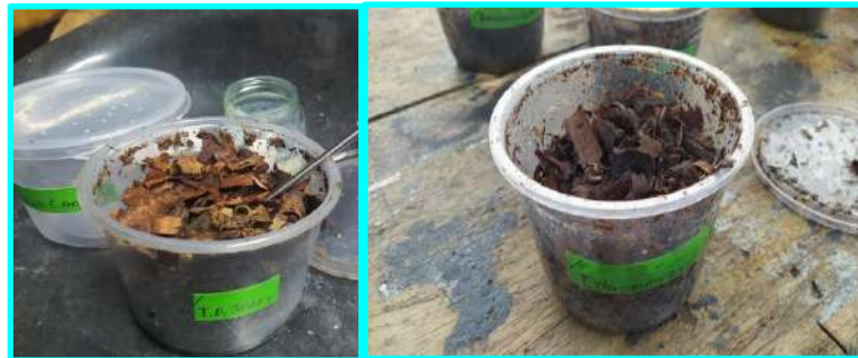
Figura.4. Mini Composteras iniciando con la degradación y sus cambios físicos. Imagen izquierda antes de comenzar la degradación, imagen derecha compost degradado después de 15 Días.
