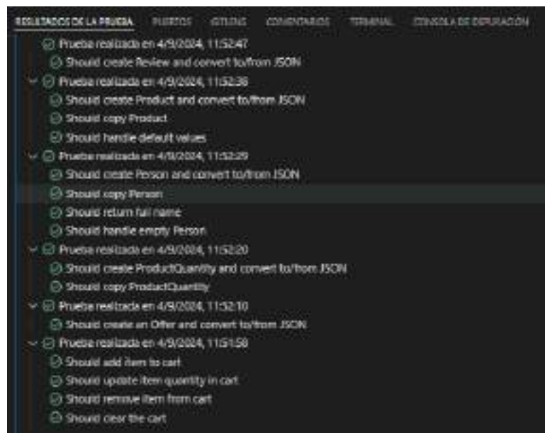
Ilustración 32. Resultado de ejecución de las pruebas unitarias para el modelo del carrito de compra.
