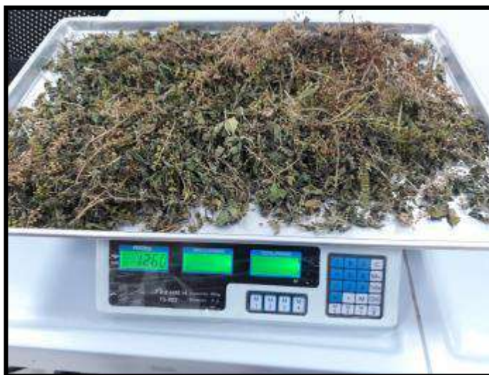
FOTOGRAFÍA 24: VISTA DEL PESO DE HOJAS DE TORONJIL LUEGO DE 180MIN EN EL SECADOR DE BANDEJAS
