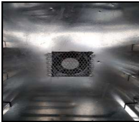
FOTOGRAFÍA 9: VISTA DEL VENTILADOR DEL SECADOR DE BANDEJAS.
