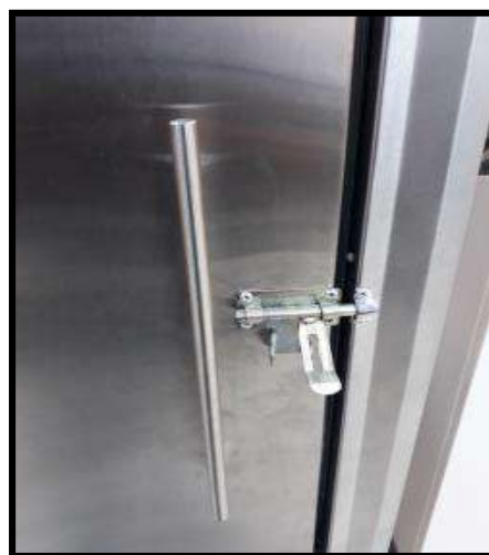
FOTOGRAFÍA 11: VISTA DE LA CERRADURA USADA PARA ASEGURAR LA PUERTA DEL SECADOR DE BANDEJA
