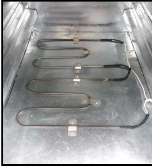
FOTOGRAFÍA 8: VISTA DE LAS RESISTENCIAS DEL SECADOR DE BANDEJAS.
