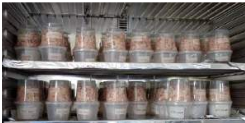
Figura 13. Microfermentación de granos de cacao en tarrinas plásticas incubadas a 35°C durante la fase anaeróbica
