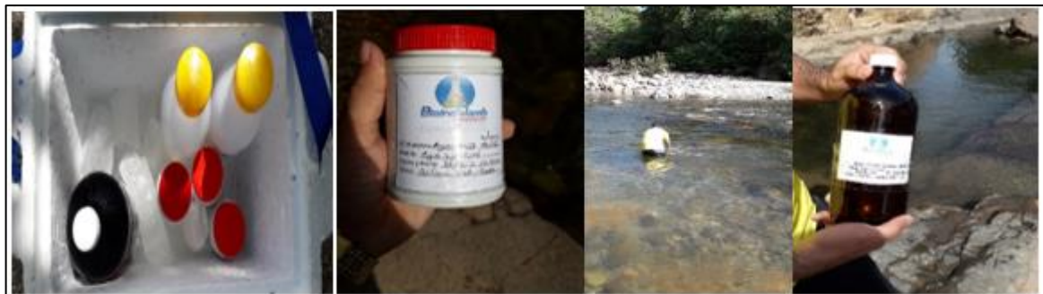
Ilustración 22. Metodología de muestreo puntual en zonas de estudio y almacenamiento de muestras de agua
