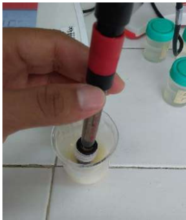
Figura 5. Potenciómetro (OHOUS STARTER 3100), utilizado para determinar el potencial de hidrogeno presente en la muestra de guanábana ( Annona muricata ).
