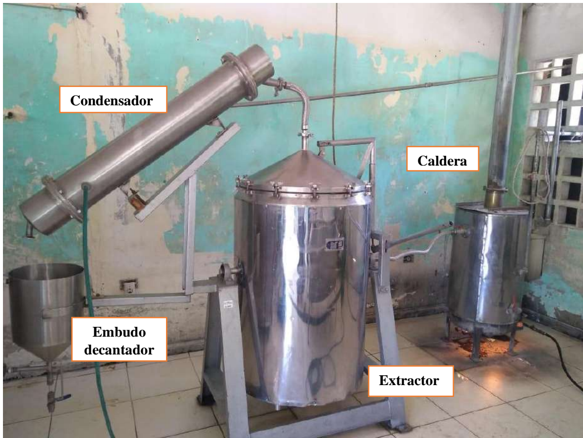
Figura 2. Planta experimental de extracción ( stanteel ).
