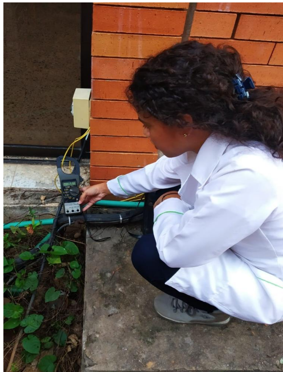
Medición de intensidad de la corriente.
