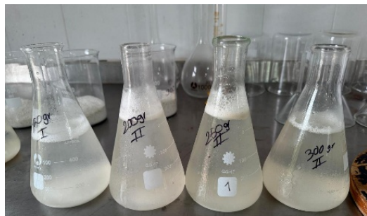
Imagen 3 Adición de ácido acético al extracto líquido para favorecer la solubilización del colágeno y estabilizar el ácido hialurónico
