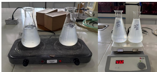
Imagen 4 Calentamiento controlado de la mezcla entre 60 y 70 °C para facilitar la desnaturalización y extracción de proteínas.
