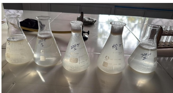
Imagen 5 Adición de cloruro de sodio para saturar la solución y precipitar el ácido hialurónico
