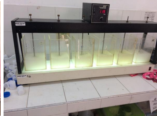
Imagen 14. Pruebas de jarra al agua residual
