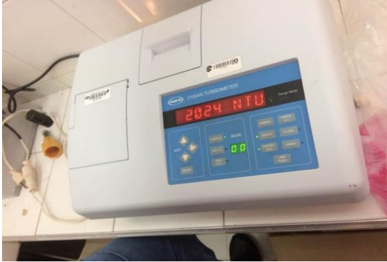
Imagen 13. Mediciones antes de las pruebas de jarra
