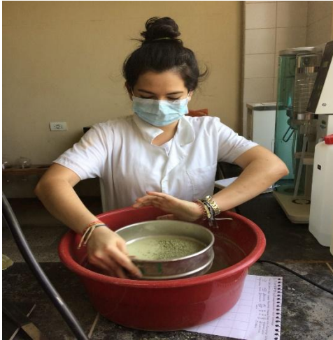
Imagen 10. Reducción de tamaño con tamiz
