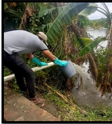
FIGURA 17 Medición de Caudal de la Tubería de Descarga Final
