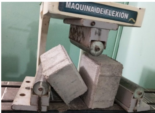
Ilustración 46. Adoquín fallado a los 28 días de curado
