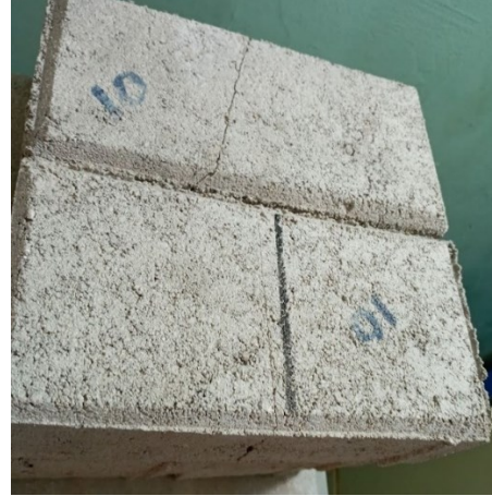
Figura 44. Adoquines luego de jalla a los 14 días de curado
