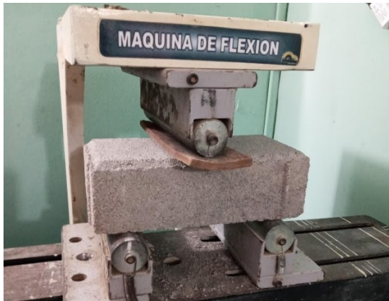
Figura 39. Adoquín para someter a falla a flexión a los 14 días de curado
