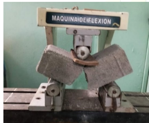
Figura 32. Adoquín fracturado a los 7 días de curado
