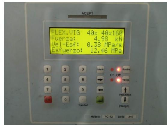
Figura 41. Resultado de falla a flexión a los 14 días de curado
