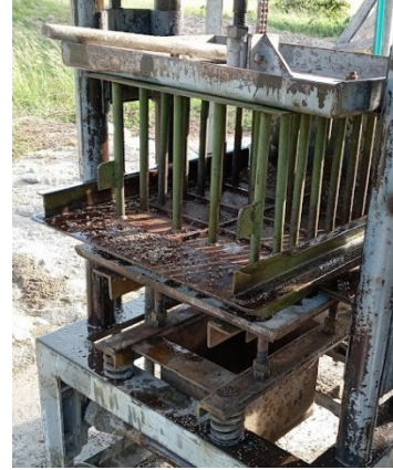
Figura 24. Maquina compactando la mezcla en los moldes Ingeniería Ambiental y Sanitaria
