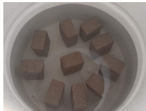
Figura 55. Adoquín húmedo, luego de 24 horas de sumergido
