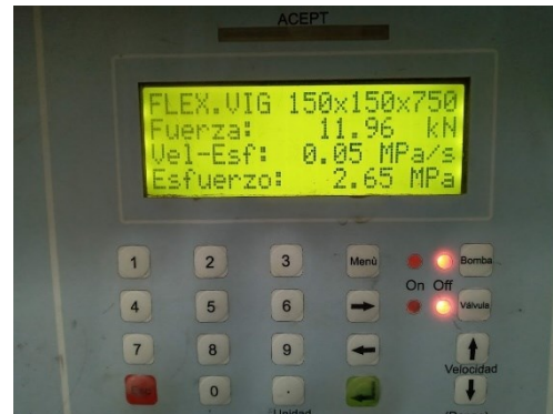
Figura 48. Resultado de falla a los 28 días de curado
