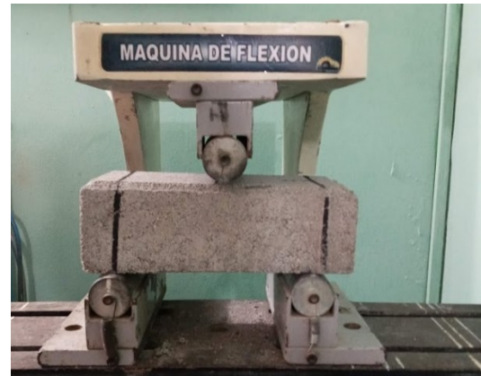
Figura 41. Resultado de falla a flexión a los 14 días de curado
