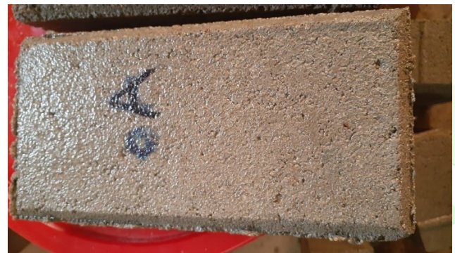
Figura 55. Adoquín húmedo, luego de 24 horas de sumergido
