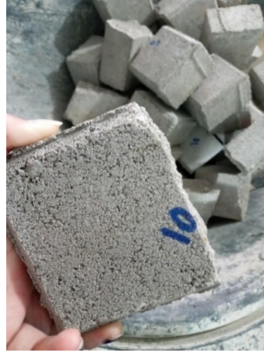
Figura 51. Adoquines fracturados a los 28 días de curado
