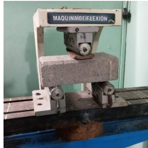
Figura 32. Adoquín fracturado a los 7 días de curado
