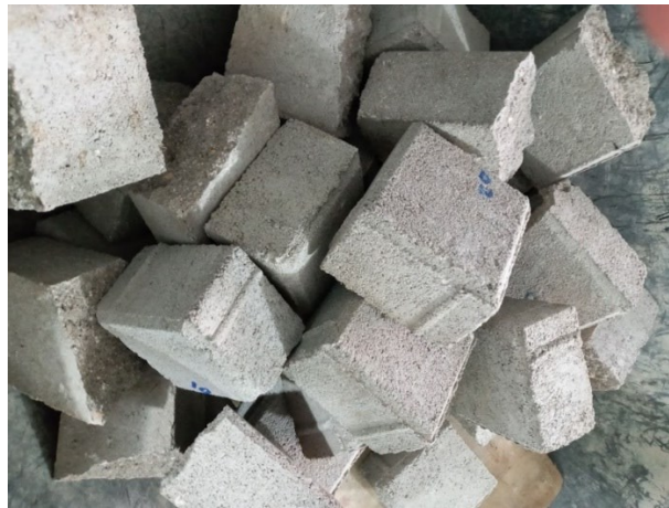
Figura 51. Adoquines fracturados a los 28 días de curado
