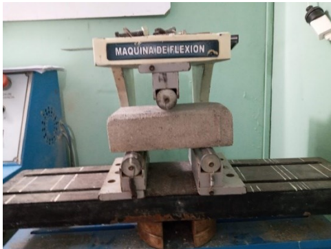
Ilustración 46. Adoquín fallado a los 28 días de curado
