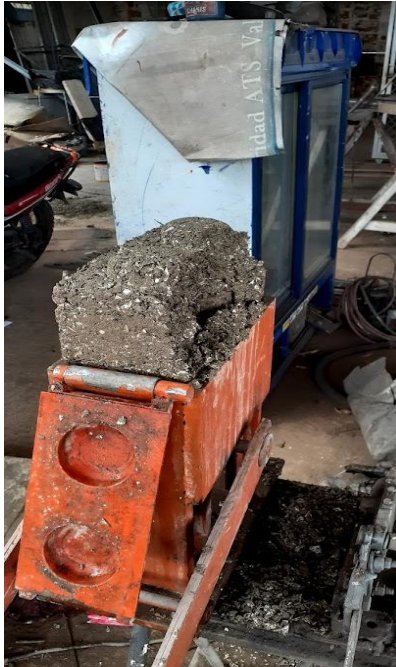
Ilustración 20. Bloque desmoronado al salir de la compactadora. Fuente: Autores, 2021.
