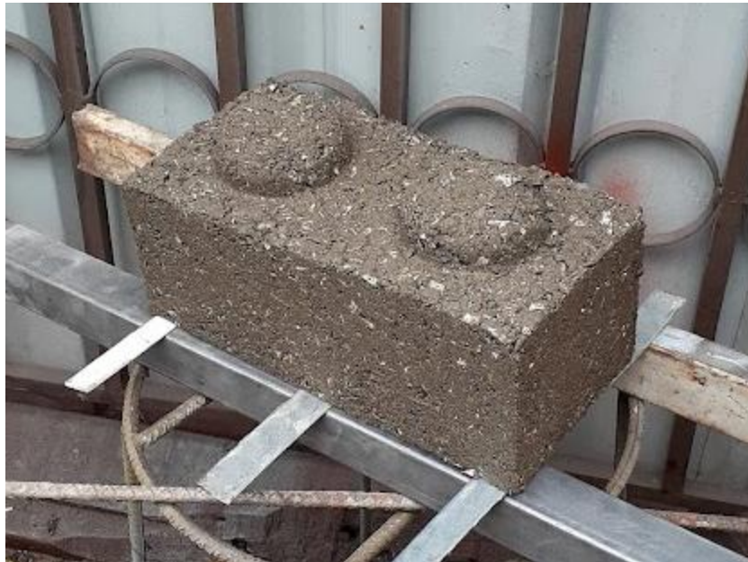
Ilustración 21. Bloque compactado en la máquina. Fuente: Autores, 2021.
