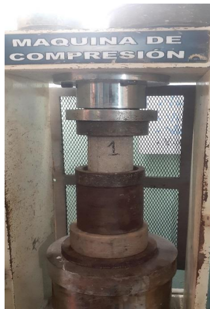
Ilustración 27. Bloque cilíndrico fallado en la máquina de compresión. Fuente: Autores, 2021.
