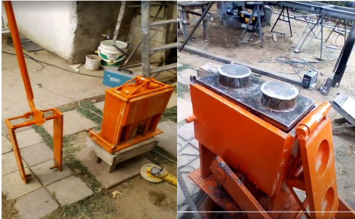
Ilustración 19. Máquina Compactadora Construida. Fuente: Autores, 2021.
