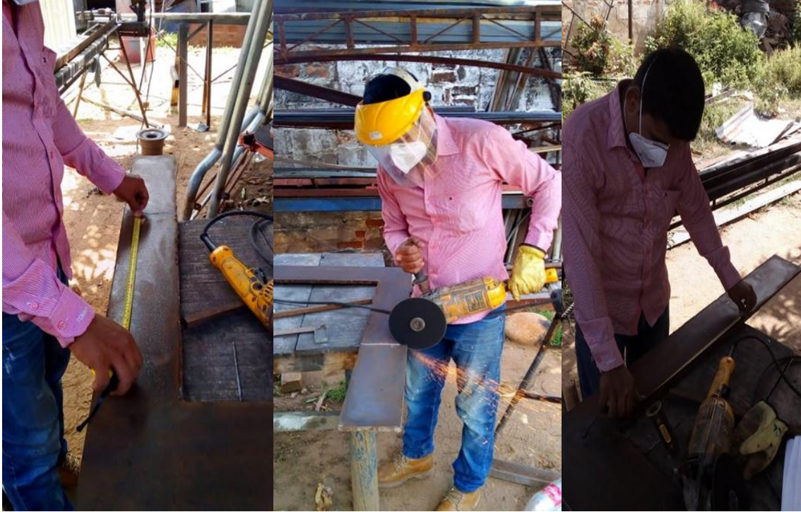
Ilustración 14. Toma de medidas y cortes de las primeras planchas. Fuente: Autores, 2021.
