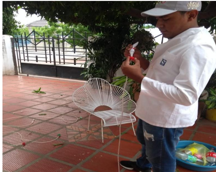
Figura 6. Sellado con silicona de los agujeros.
