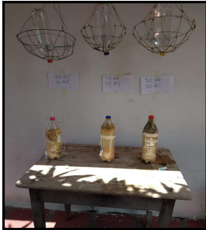
Figura 13. Reactores según su composición agua residual/residuos sólidos.
