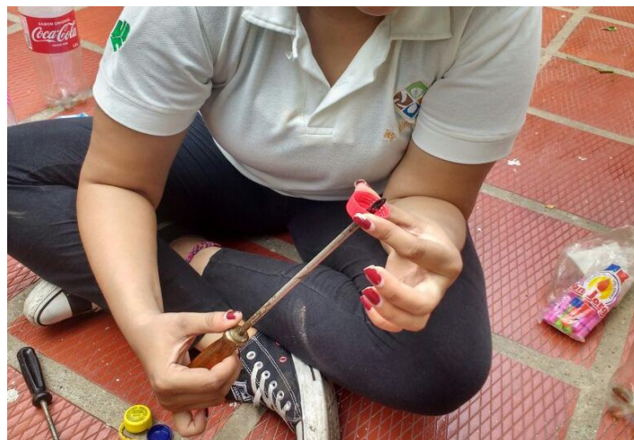
Figura 5. Realización de agujeros en las tapas del reactor.
