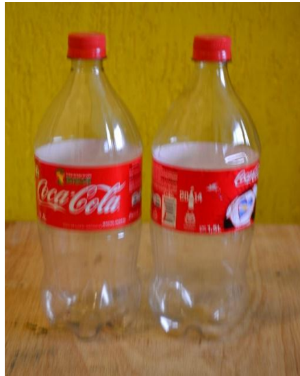
Figura 4. Botellas plásticas para la construcción del reactor.
