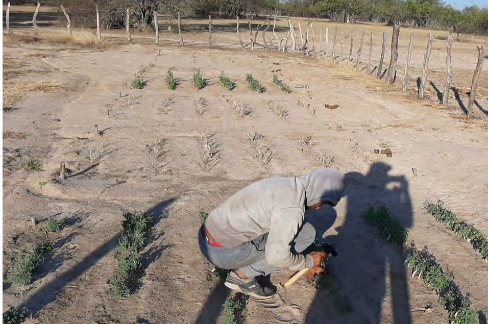
Figura 23: Toma de muestras por el método del cilindro.
