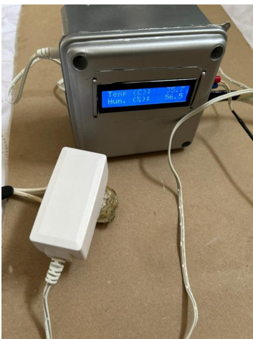
Figura 38. Sistema de adquisición de datos alimentado a 9V.
