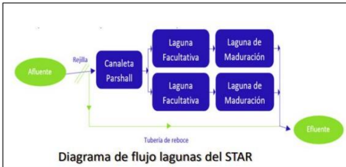
Figura 4. Diagrama de flujo para el proceso de tratamiento de la planta
