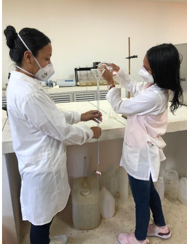
Imagen 26. Preparando muestras para la titulación de alcalinidad
