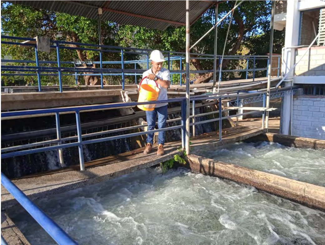
Aplicación del trazador en mezcla rápida
