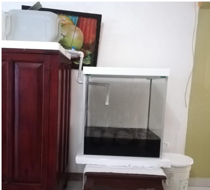
Adecuación del filtro de carbón activado
