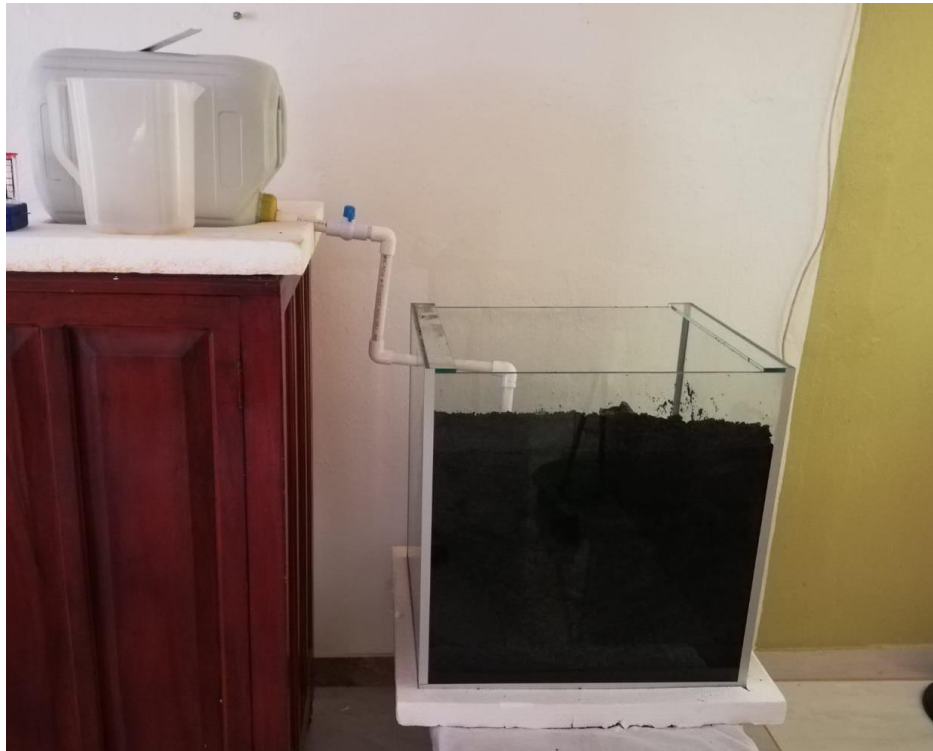
Adecuación del filtro de carbón activado
