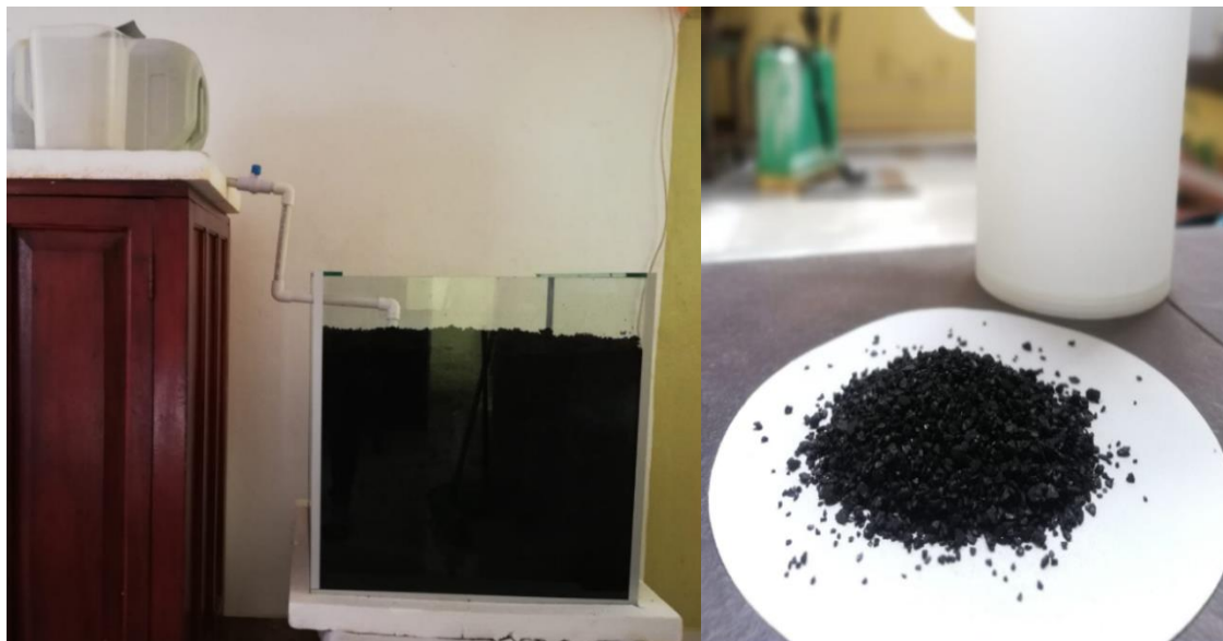
Ilustración 4 Montaje del filtro de carbón activado.
