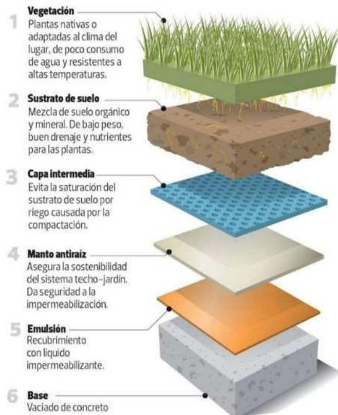
Figura 4. Componentes de una cubierta verde.
