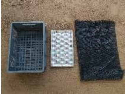
Base, Capa drenante y membrana antiraíz
