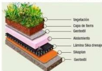
Fig. 2. Esquema de una cubierta verde
