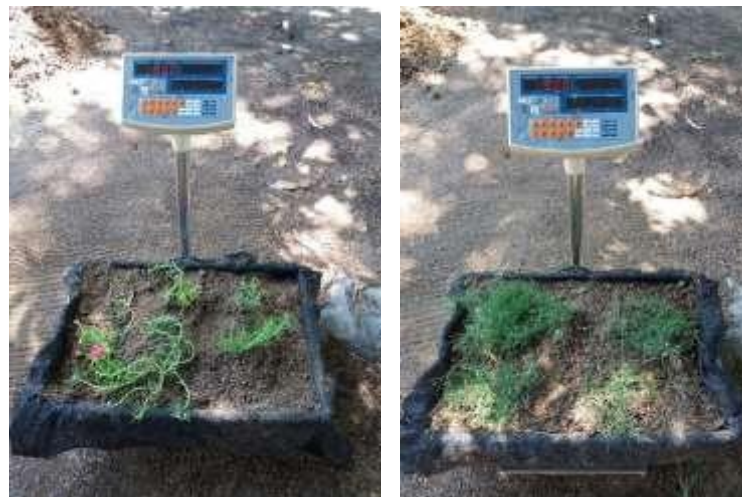
Figura 16. Peso de la cubierta verde en estado de saturación.
