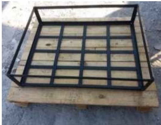
Figura 19. Estructura de soporte para la cubierta verde.
