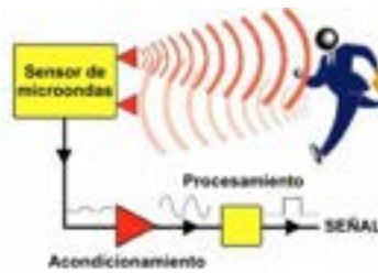
Ilustración 7. Funcionamiento Sensor Microondas [11]
