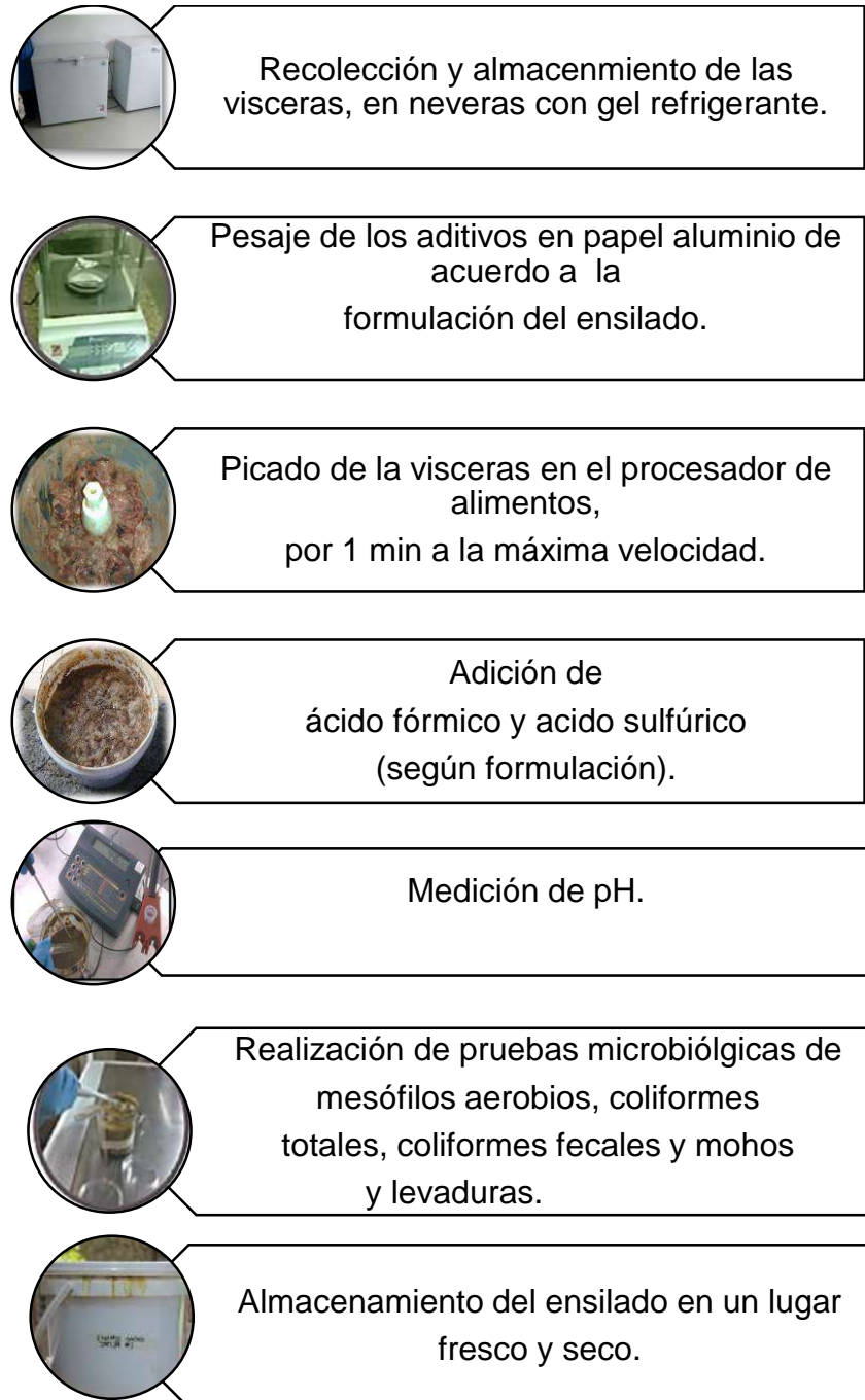
Figura 1. Diagrama de preparación del ensilaje químico de visceras de tilapia roja
