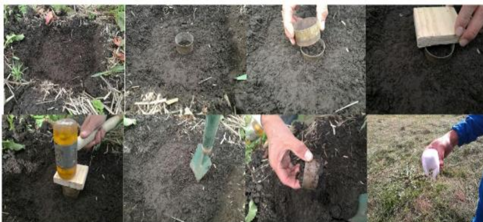
Figura 1. Toma de muestra no disturbada de suelo con anillos metálicos
