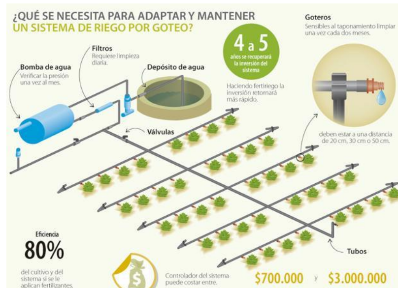
Figura 4. Riego por goteo.
