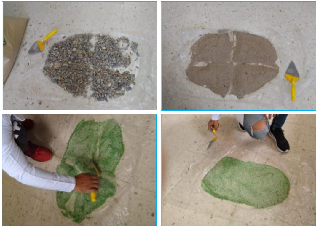
Ilustración 10: Cuarteado de los agregados arena, grava y vidrio molido.
