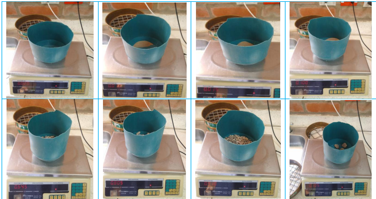
Ilustración 12: Pesaje de los agregados arena y grava.
