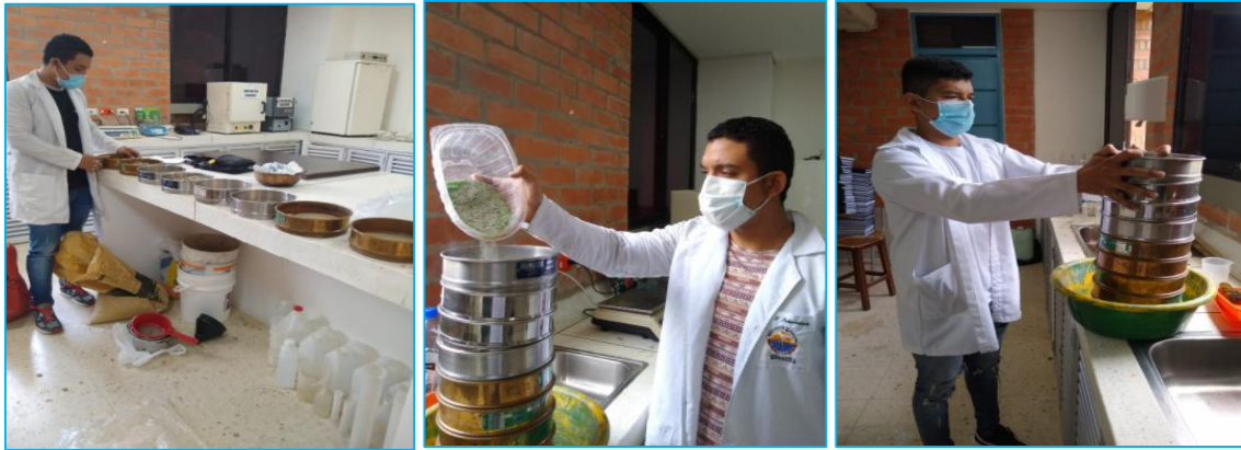
Ilustración 11: Orden de tamices para las granulometrías de los agregados.
