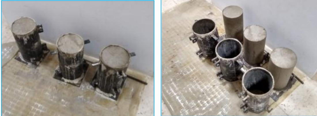
Ilustración 22: Encofrado y desmolde de los cilindros.
