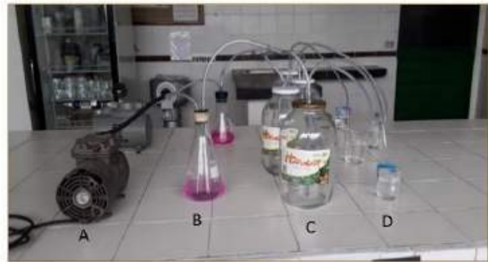
Figura 7. Montaje para la determinación de la intensidad respiratoria
