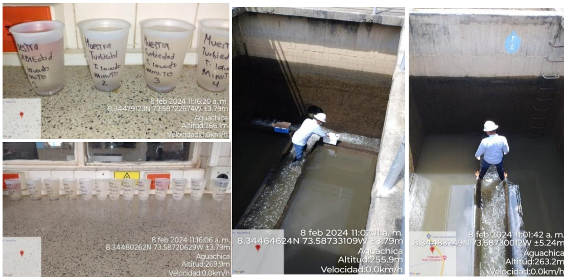
Figura 8. Evidencia fotográfica recolección de muestras, prueba determinación del tiempo óptimo de lavado de un filtro.
