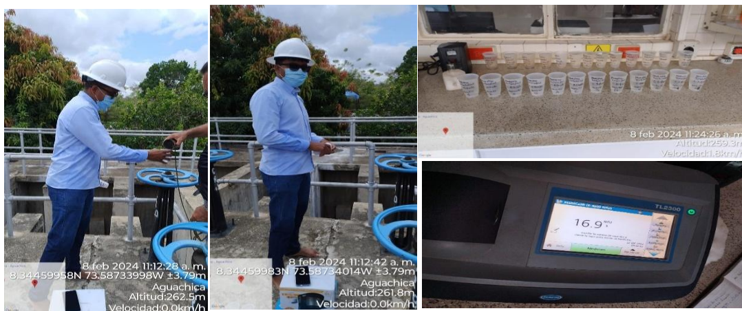
Figura 9. Evidencia Fotográfica, Recolección y Análisis de Muestras, Prueba Calidad del Filtrado Inicial.
