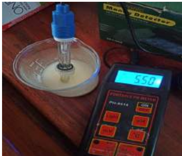
Montaje para la medición de acidez del queso. -
