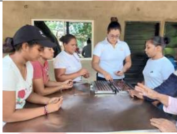
Revisión calidad del grano, con prueba de corte en la guillotina
