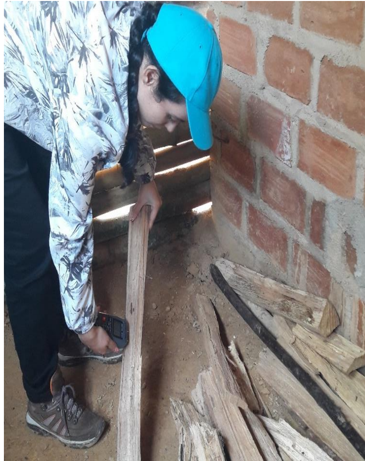
Ilustración 6. Medición humedad en el combustible
