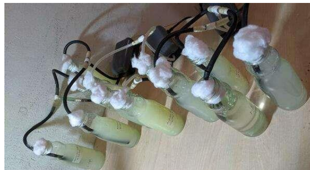
Ilustración 17. Montaje de los reactores con las diferentes concentraciones de lactosuero
