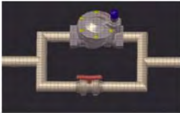
Anexo 3. Sistema hidrodinámico para regular agua en el tanque de almacenamiento.
