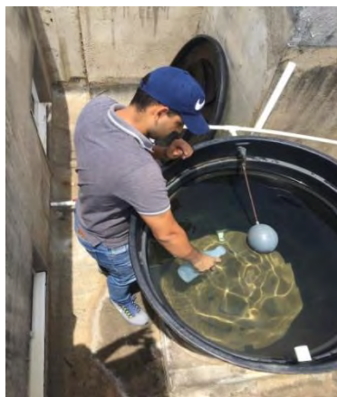
Figura 6. Recolección de la muestra dentro del tanque.
