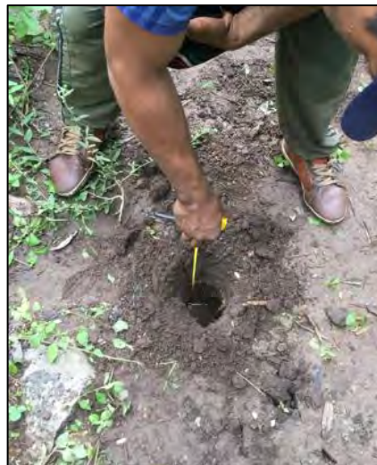
Ilustración 13. Medición en punto de sondeo y muestra para ensayo de infiltración
