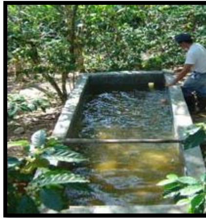
Figura 12. Depósitos de agua para el lavado de fibras de fique.
