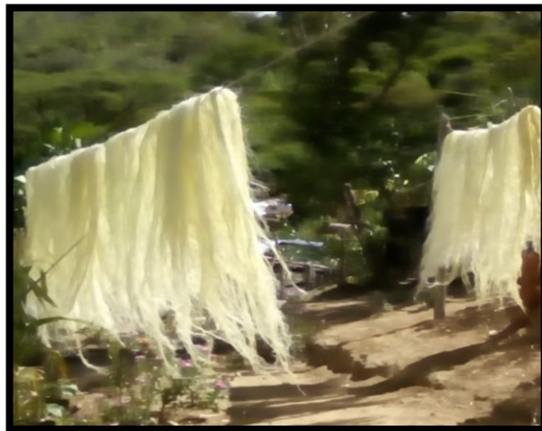
Figura 13. Proceso de Secado mediante exposición al sol de las fibras de fique.
