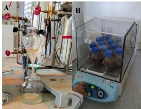
Figura 10. Montaje de extracción SENA Tecnoparque nodo Valledupar. Arrastre con Vapor de Agua (A) y Método por Inmersión(B).
