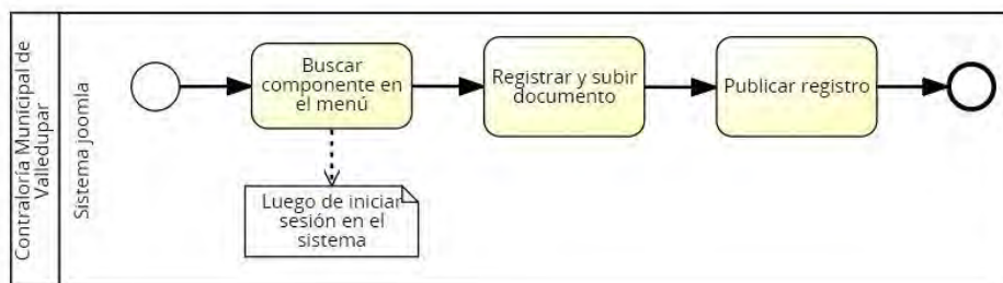
Ilustración 30 Diagrama del proceso cargar documentos (TO-BE)
