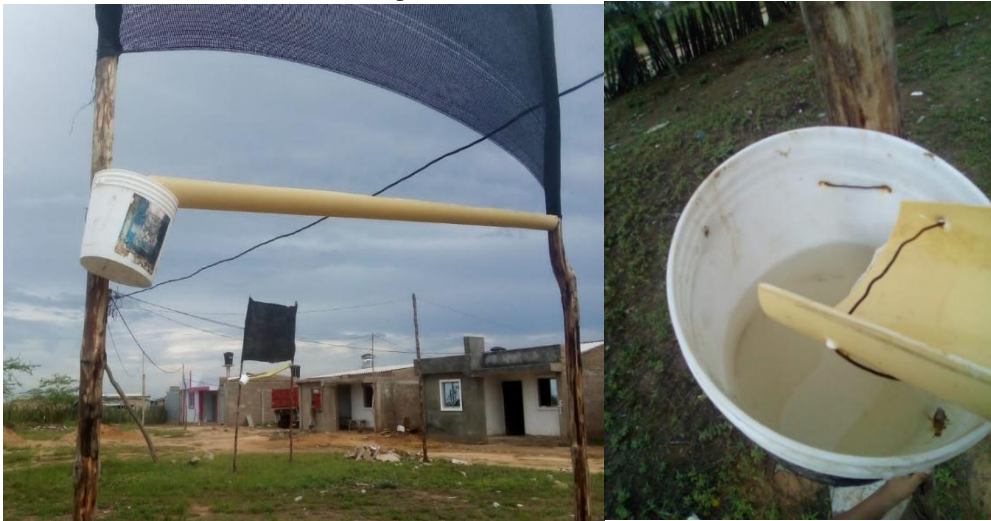
Figura 13. Funcionamiento del sistema de captación.
