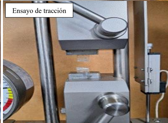
Colocación de la muestra para ensayo de tracción
