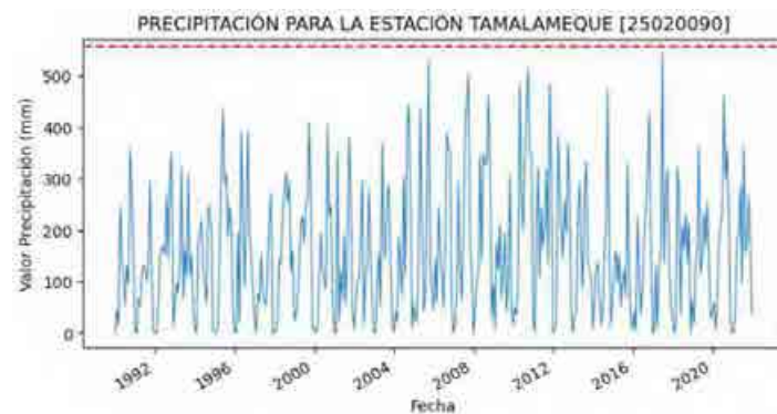
Figura 46. Evolución Temporal de la Precipitación sin Datos Atípicos para la Estación del Municipio del Tamalameque
